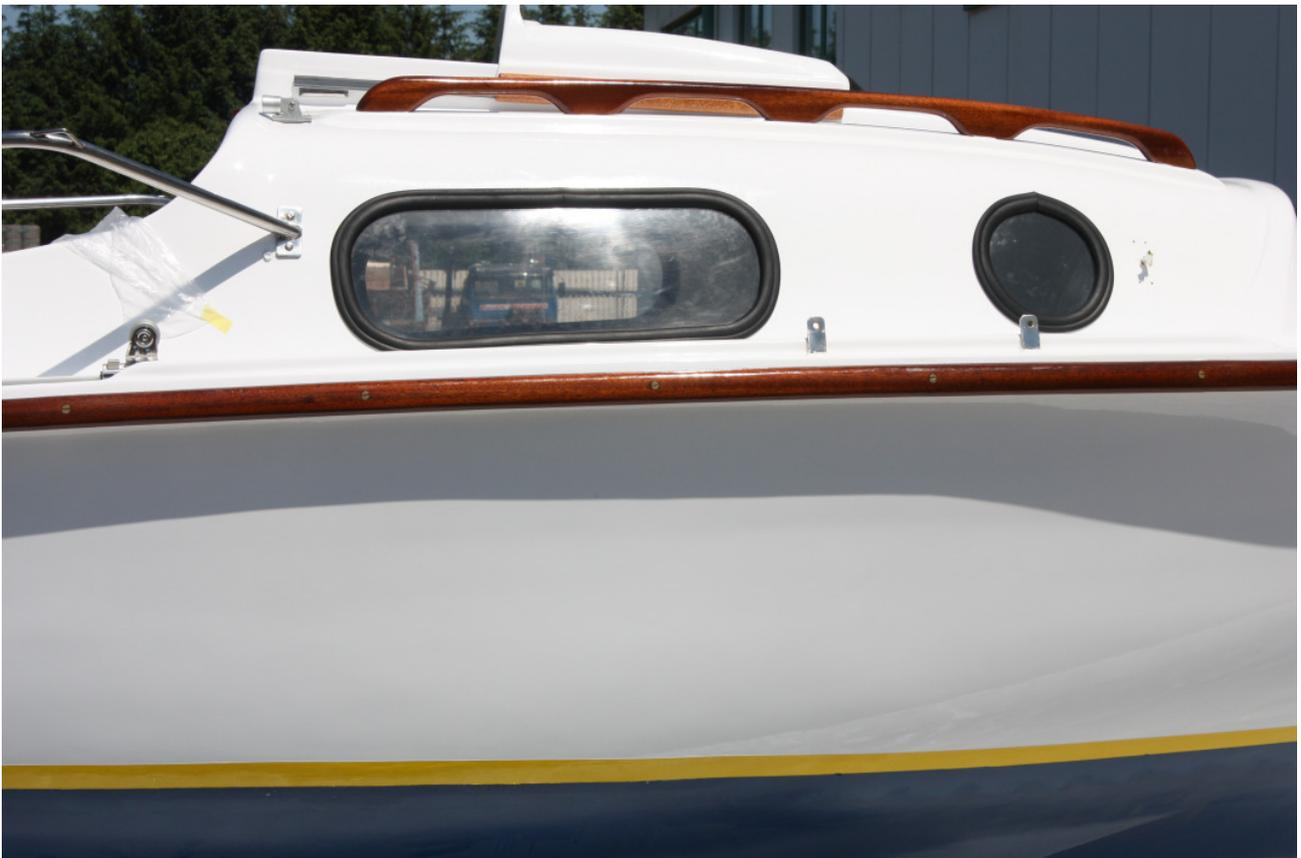
Scheuerleisten wurden komplett demontiert, geschliffen und 10-fach mit Le Tonkinois gestrichen. Alle Messingschrauben wurden durch neue ersetzt.
