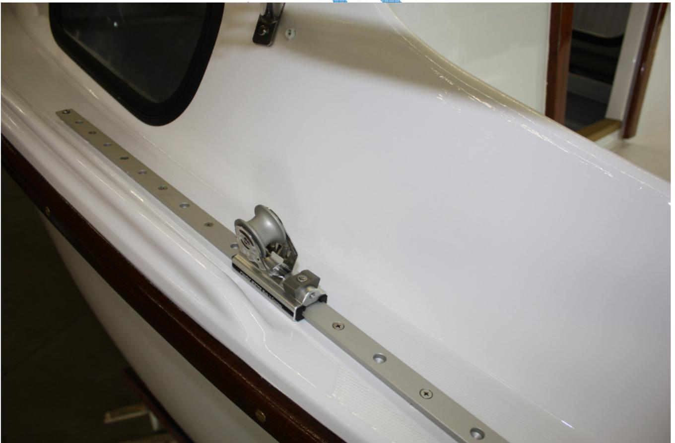
Neue Genuaschienen und -schlitten. Die Originalschienen aus Kunststoff dienten als Vorlage dieser Sonderanfertigung durch Pfeiffer Marine.
